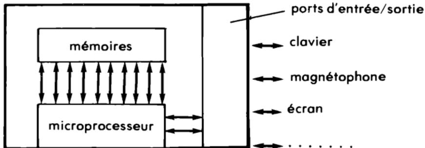
**ECRAN :** c'est votre téléviseur, ou un moniteur. Vous lui transmettez des signaux via la prise PERITEL ou l'entrée UHF (prise d'antenne) avec un modulateur. Ces signaux contrôlent les faisceaux lumineux qui créent l'image sur l'écran.
